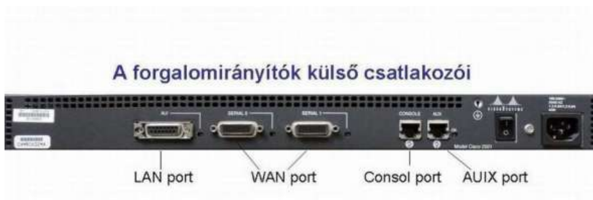
9. ábra. A forgalomirányítók külső csatlakozói
