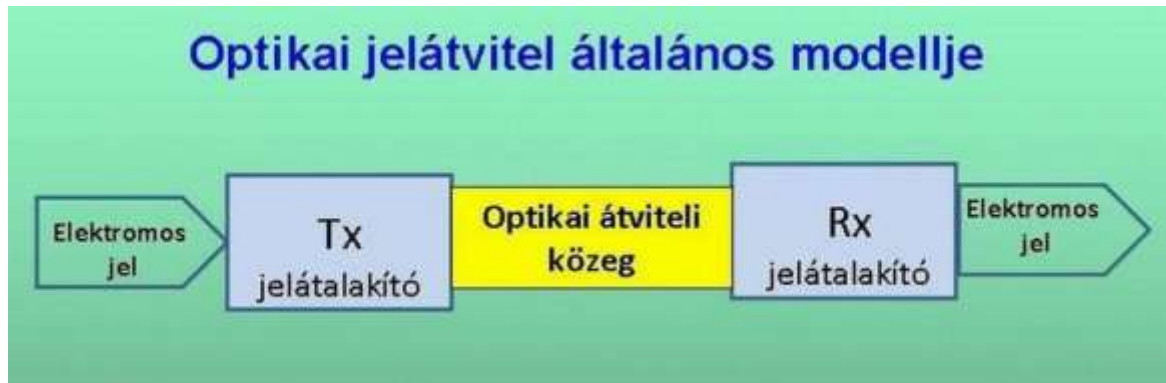
7. ábra. Optikai kábel működési elve
