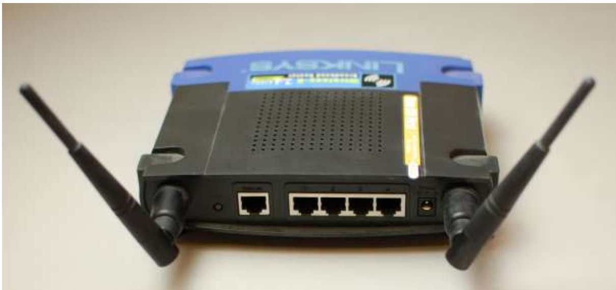
13. ábra. Vezeték nélküli router
