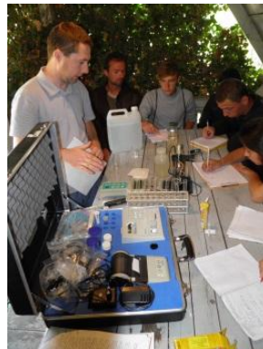
64. ábra. A hordozható spektrofotométerek széleskörűen alkalmazhatók terepi körülmények között
