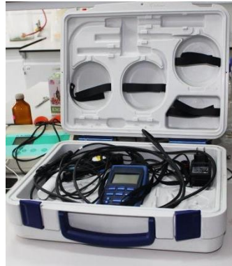
63. ábra. Multifunkciós terepi mérőműszer
