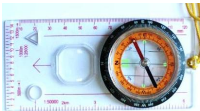
26. ábra. Tájéolóval kiegészített iránytű
