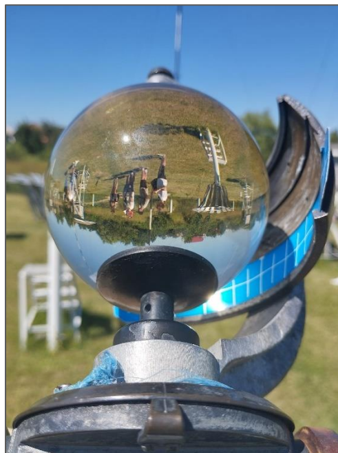
15. ábra: Campbell–Stokes-féle heliográf (saját felvétel, Beregszász, 2024)
