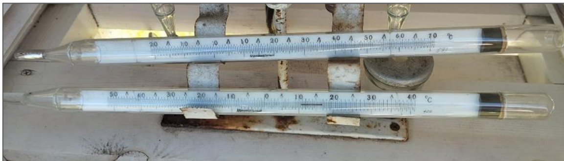
17. ábra: Fuess-féle maximum és minimum hőmérő (saját felvétel, Beregszász, 2024)
