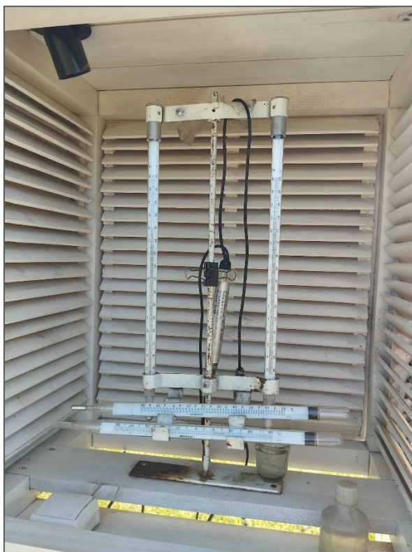
10. ábra: A pszichrométer házika és műszerei – függőlegesen a száraz és a nedves hőmérők, közöttük az elektromos hőmérő, vízszintesen a maximum és minimum hőmérők (saját felvétel, Beregszász, 2024)
