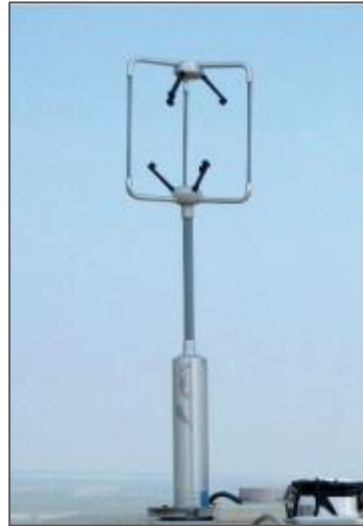
35. ábra: Szónikus anemométer (Tóth, 2021)
