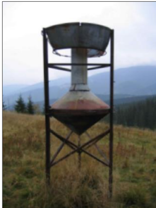
68. ábra: Mougin-féle csapadékgyűjtő a Fekete-Tisza forrása felett (Mészáros, 2013)
