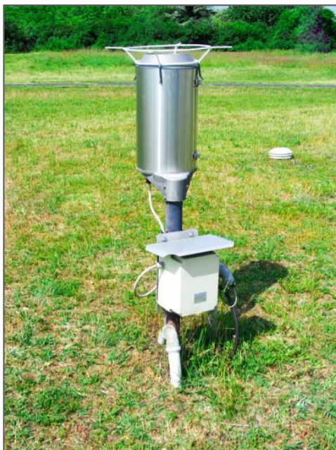
83. ábra: Elektronikus billenőedényes csapadékmérő műszer ( https://www.met.hu/omsz150/pages/galeria )
