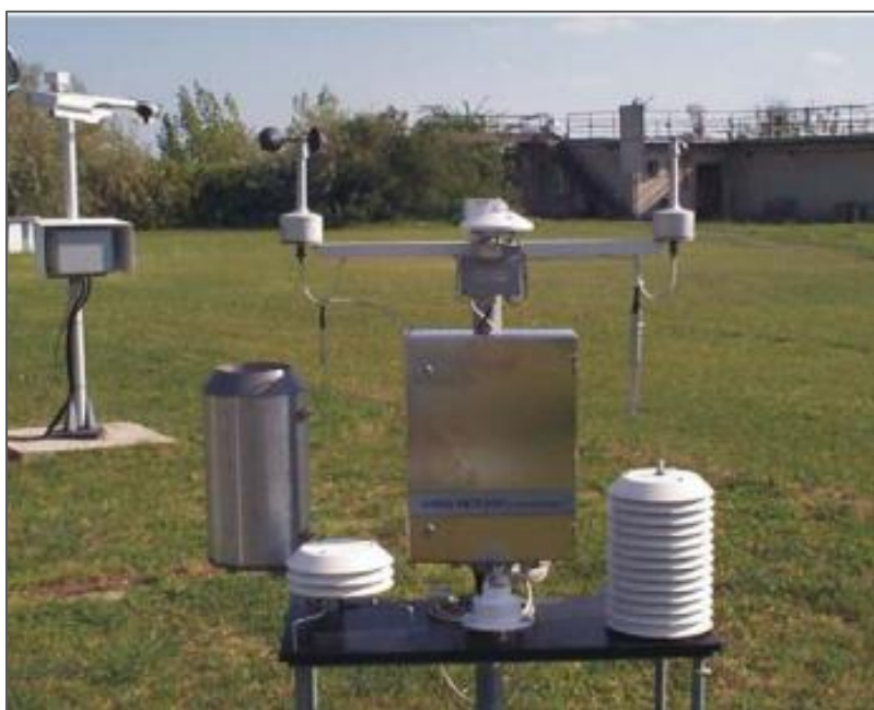
82. ábra: A MILOS 500 automata adatgyűjtője és érzékelői (OMSZ útmutató, 2018)
