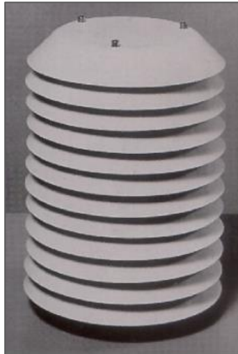
5. ábra: Elektromos hőmérő árnyékolására használt lapok (Mészáros, 2013)
