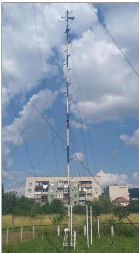
8. ábra: A szélirány és szélesebségmérő egy 10 m magas oszlopon (saját felvétel, Beregszász, 2023)
