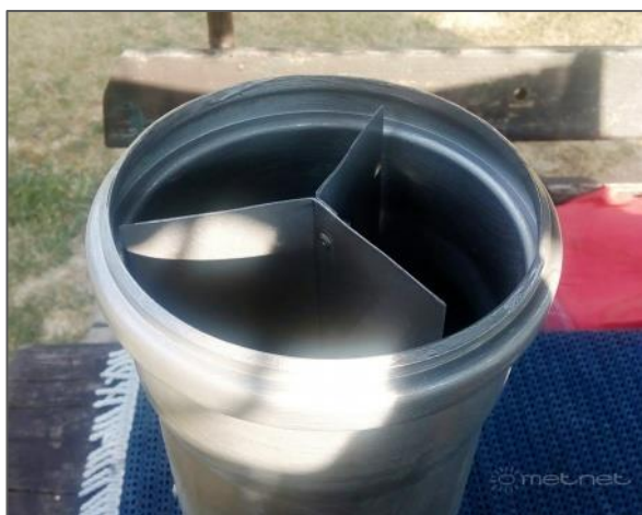
65. ábra: Hókeresztrel ellátott ombrométer
