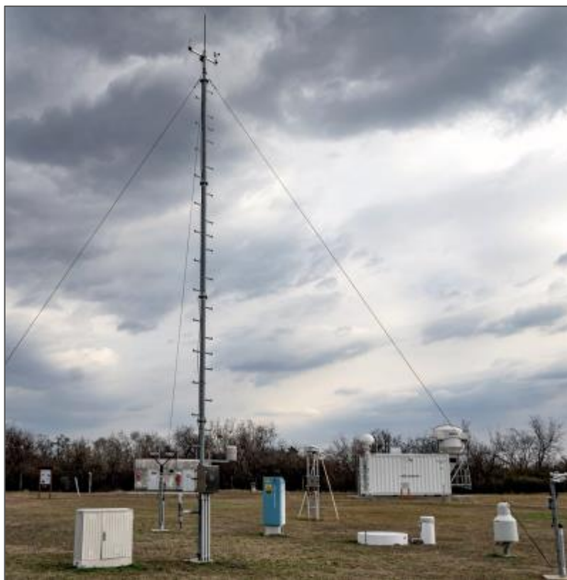
81. ábra: Automata meteorológiai állomás (Tóth, 2021)
