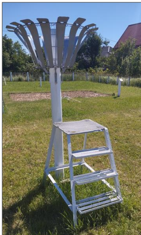
67. ábra: Tretyakov-féle ombrométer Nipher-féle szélgallérral (saját felvétel, Beregszász, 2024)
