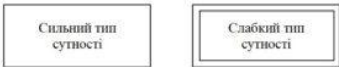
Рис. 1. Позначення сильного та слабого типу сутності
