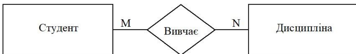
Рис.8. Відображення зв'язку типу “багато до багатьох”
